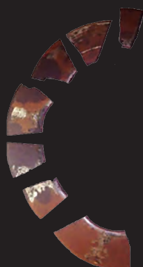
Ressort disque défaillant
