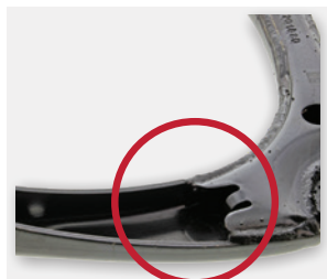
CORPS DE BRAS DE SUSPENSION Le corps de bras de suspension utilise une conception de coquille partielle en acier estampé
