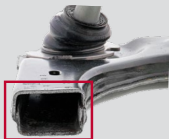
CORPS DE BRAS DE SUSPENSION Conception de coquille creuse en acier estampé
